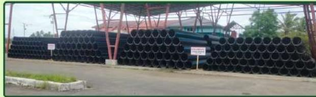
Pipa yang digunakan dalam mendistribusikan air adalah Pipa HDPE (*High Density Polyethylene*), terbuat dari bahan polimer polyethylene dengan kepadatan tinggi yang berasal dari minyak bumi.
